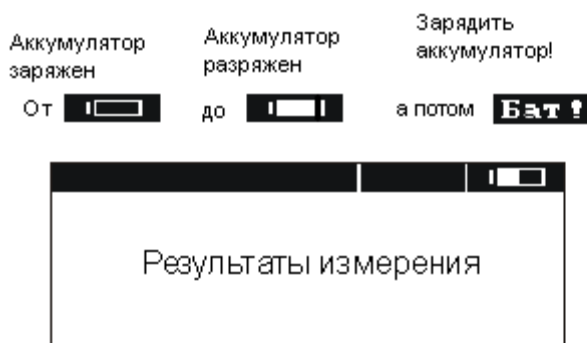
Контроль состояния зарядки аккумуляторов
